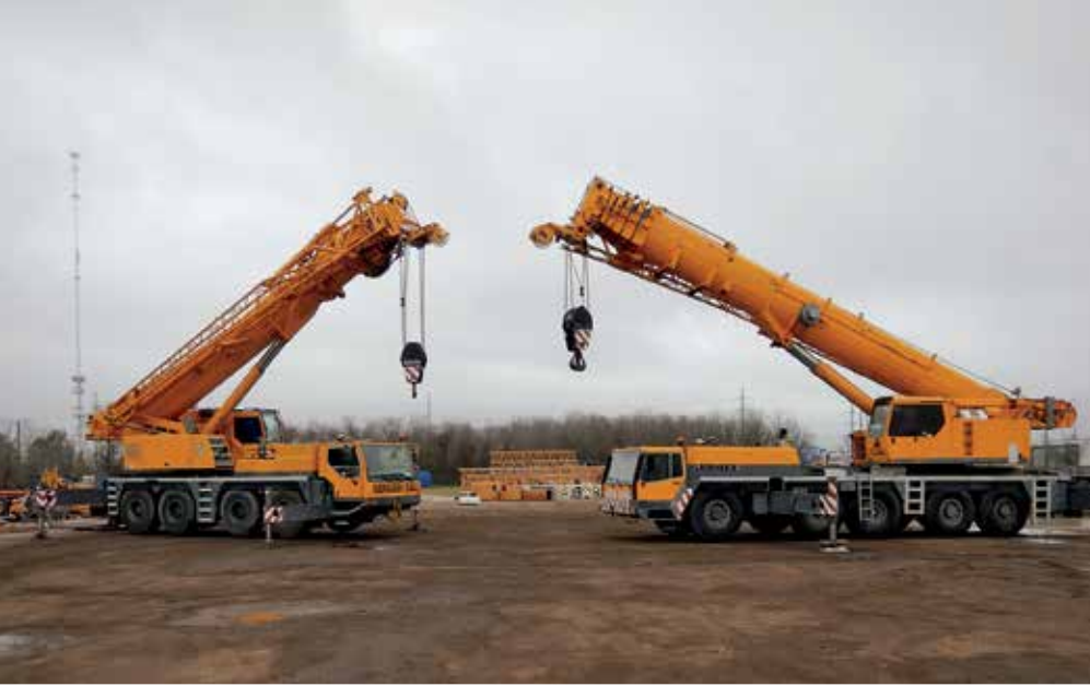
Liebherr LTM1160-2 200 Ton & Liebherr LTM1100-4 120 Ton
